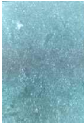
рис.2 Модифицированный сплав, проба отлита сразу после модифицирования гранулами фосфида меди.
