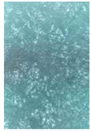
рис.4 Модифицированный сплав, проба отлита после 5 часов выдержки при температуре расплава 780 °С
