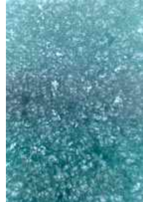
рис.7 Модифицированный сплав после переплава, проба отлита через 4 часа после расплавления слитка и доводки температуры сплава до 780 °С
