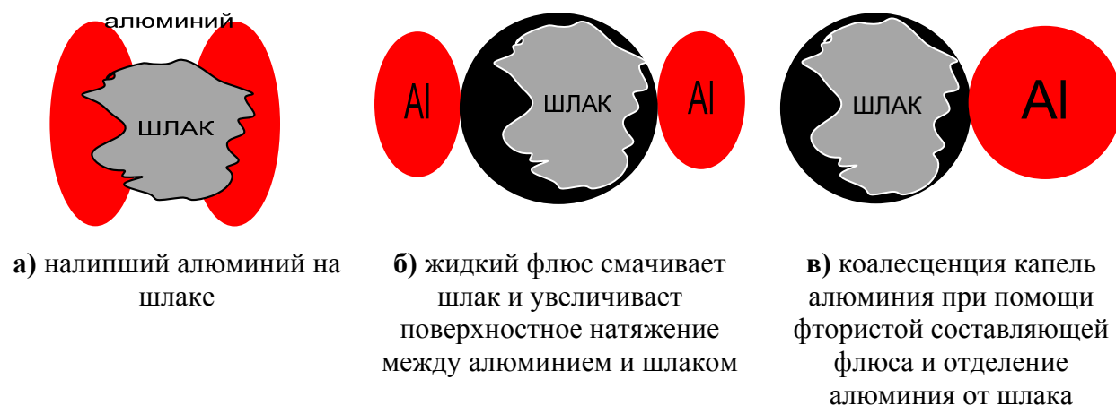
Рис. 3 Схема процесса отделения алюминия от шлака с помощью флюса
