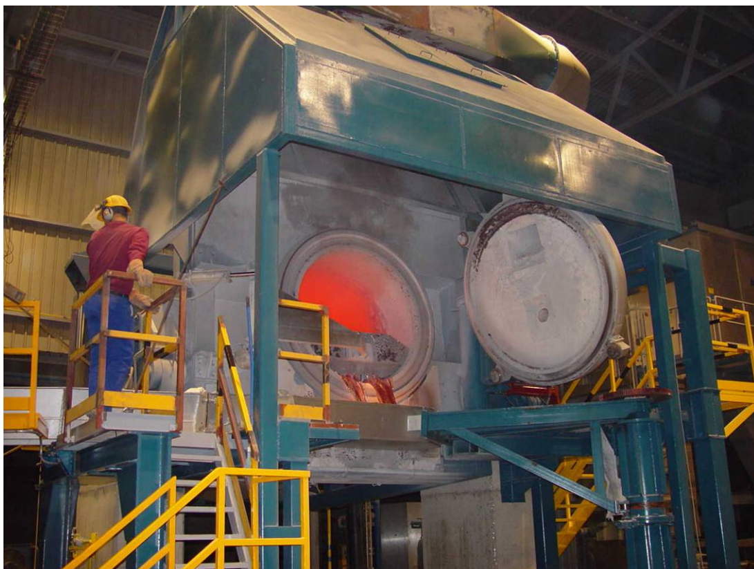
Рис. 5 Наклонная роторная печь TTRF (16 тонн), Испания
