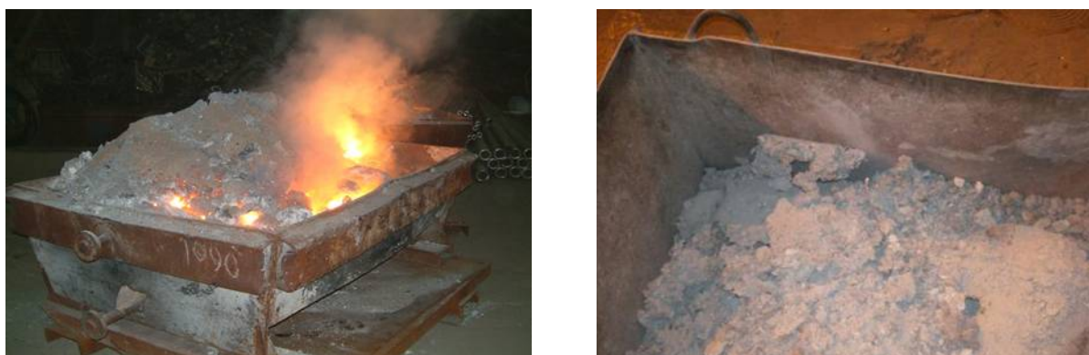
Рис. 4 Шлак без обработки флюсом (слева), и обработанный флюсом (справа)
